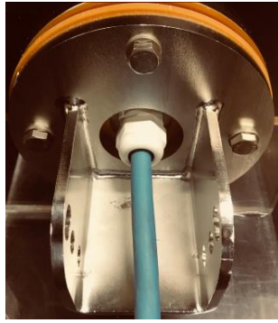
Kabelverschraubung in den Flansch eingeschraubt AT-002883
